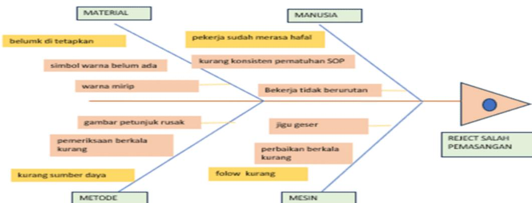
**Gambar 3. Diagram Fishbone Reject Salah Pemasangan**
