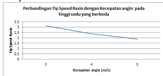
Pada Grafik diatas dapat di lihat *Tip Speed Ratio* mengalami penurunan meski kecepatan angin bertambah tinggi, Sedangkan tinggi sudu tidak mempengaruhi *Tip Speed Rasio* tersebut terlihat pada perbedaan tinggi sudu perhitungan *Tip Speed Ratio* sama.
