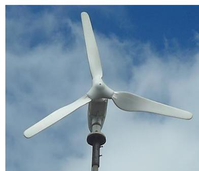
Gambar 3.4 HAWT 300 W sudu 3 [Sumber : Data Pengujian]
