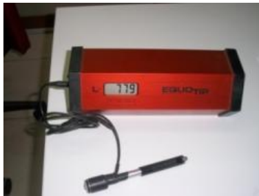
Gambar 3 Mesin uji kekerasan EQUOTIP
