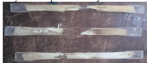
Gambar 9 Mekanisme Patahan Spesimen Uji Tarik
