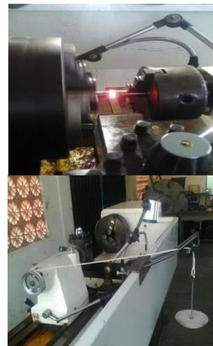
Gambar 8. Pengelasan gesek pada mesin bubut
