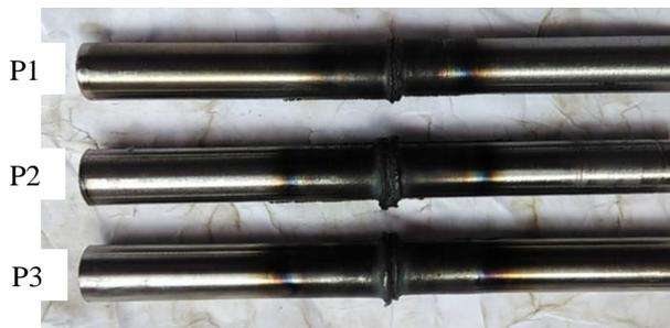
Gambar 10. Hasil sambungan *friction welding*
