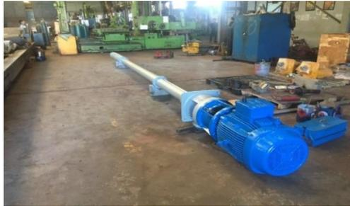
Gambar 1. *Centrifugal Vertical multistage pump* dan motor penggerak
