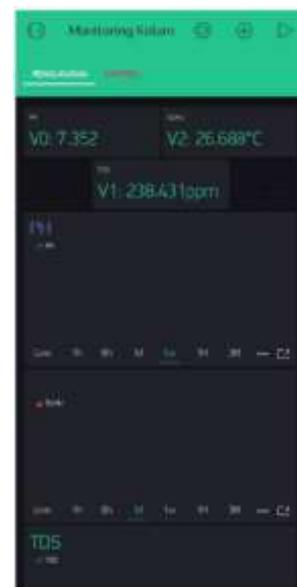
Gambar 7. Pembuatan sistem pemantau dengan aplikasi Blynk
