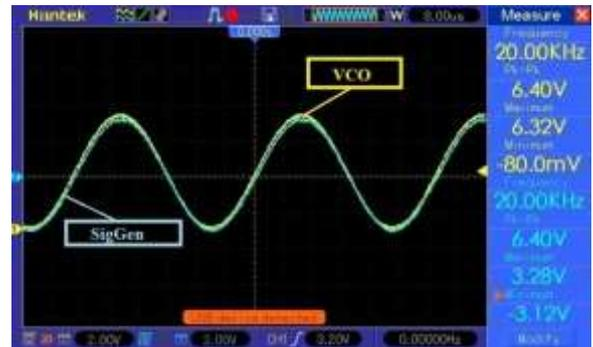
Gambar 12. Hasil Kalibrasi Sinyal keluaran VCO terhadap *Signal Generator* (warna kuning VCO dan biru *Signal Generator*)
