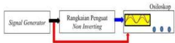
Gambar 5. Skema pengujian rangkaian penguat non inverting
